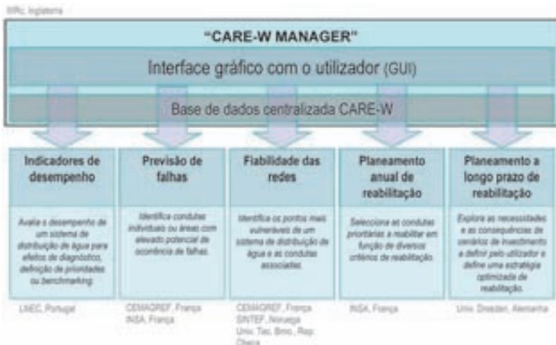
Figura 9.45 – Componentes principais do protótipo CARE-W
