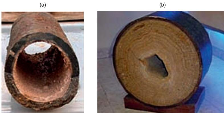
**Figura 2.10 – Exemplo de incrustação em conduta de (a) material cimentício (fibrocimento) e (b) conduta metálica**
