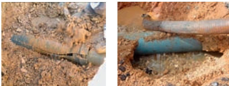
Figura 2.14 – Roturas longitudinais em condutas de PVC
