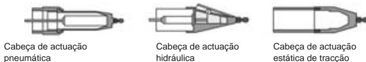
**Figura 10.27 – Cabeças cónicas das unidades de rebentamento da conduta**
