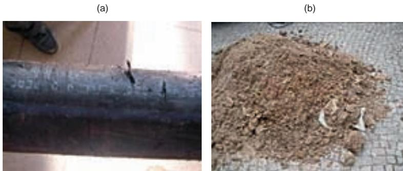
**Figura 2.21 – Rotura em conduta de polietileno: (a) lesões na parede de conduta; (b) materiais sobrantes da escavação incluindo pedras e objectos de faces cortantes**
