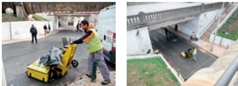
**Figura 9.2 – Inspeção com geo-radar para identificar a localização de condutas enterradas**
