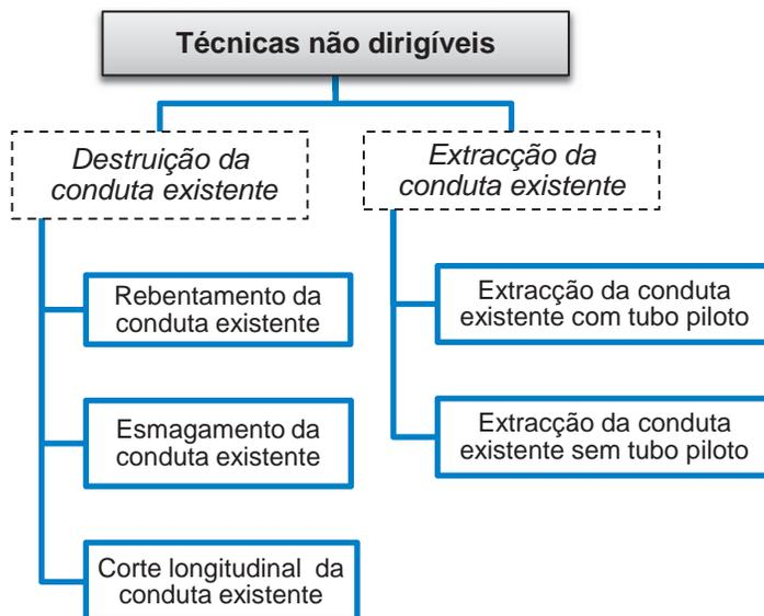
Figura 10.23 – Técnicas não dirigíveis de substituição
