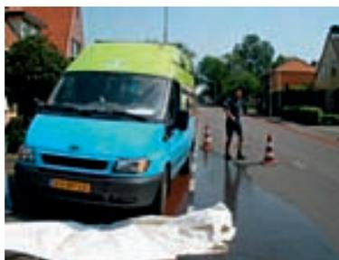
Figura 9.23 – Realização do teste RPM para medição da turvação
