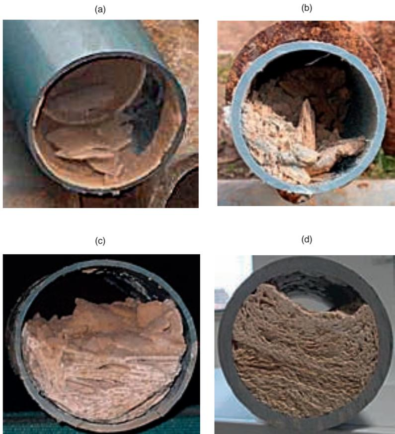
Figura 2.11 – Exemplos de incrustação em condutas de materiais plástico (o caso do PVC): (a) formação e desagregação de camadas de carbonato de cálcio ( $\text{CaCO}_3$ ); (b) exemplos de formas de deposição não coesiva de  $\text{CaCO}_3$ ; (c) e (d) exemplos de formas de deposição coesiva de  $\text{CaCO}_3$
