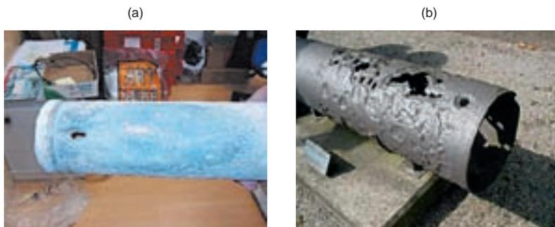
**Figura 2.6 – Conduitas furadas por efeito de corrosão: (a) corrosão localizada; (b) corrosão por correntes vagabundas**
